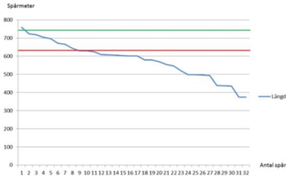
Figur 13: Fördelning av spårlängder och hjälplinjer för 630 (röd) respektive 740-750 meter (grön).
