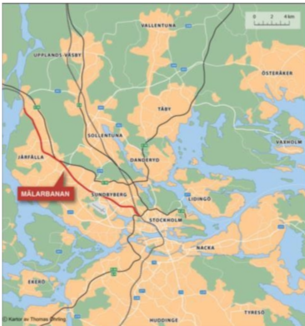
Figur 41: Sträcka av Mälarbanan som byggs fyrsparig (källa: Trafikverket).
